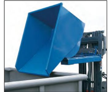
Bennes autobasculantes en série avec câble qui permet de déclencher le basculement à partir du siège du conducteur.
