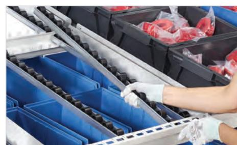
Pas d'outillage nécessaire pour adapter à l'utilisation de contenants de différentes tailles.
